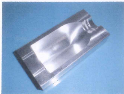
Abb. 2. HSC-Bearbeiten kürzt beim Fertigen von Formen aus Aluminium wesentlich die Durchlaufzeiten
