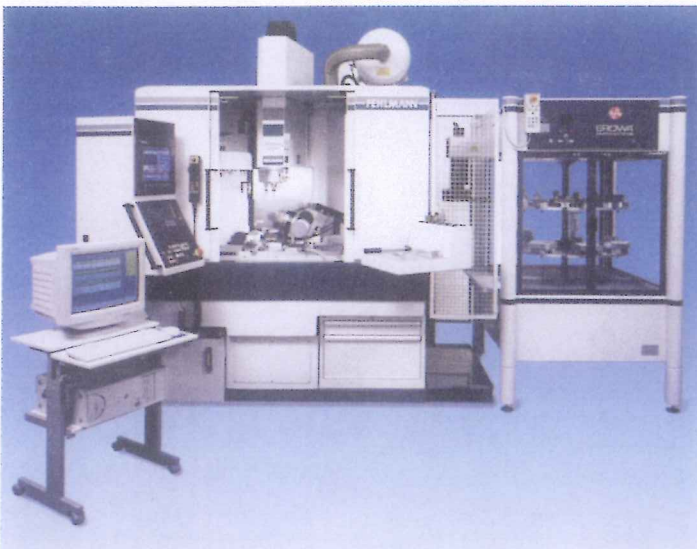
Abb. 6. Präzisions-Bearbeitungszentrum mit Werkzeugmagazin und Job-Manager zum einfachen, tabellarischen Programmieren bedienerlos abzuarbeitender Fertigungsaufträge
