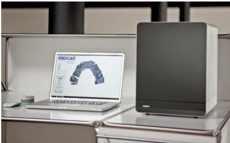
Bild 4. Digitale Welten: Mithilfe digitaler Scanner lassen sich die Zahnbilder rekonstruieren und im CAM-System frästechnisch abbilden
